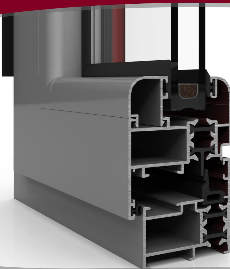
Carpintería practicable de 50mm. Rotura de puente térmico mediante pletinas de poliamida de 15mm, consiguiendo así un valor de transmitancia térmica al marco de hasta  $U_{h,m} = 3,4 \text{ W/m}^2\text{K}$  para doble acristalamiento. De esta forma, podemos conseguir valores de hasta  $U_h = 1,4 \text{ W/m}^2\text{K}$ , según dimensiones y modelo de vidrio instalado.
